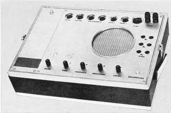
Links: Bild 7. Das Kontrollgerät ML 101 mit 5-W-Verstärker
